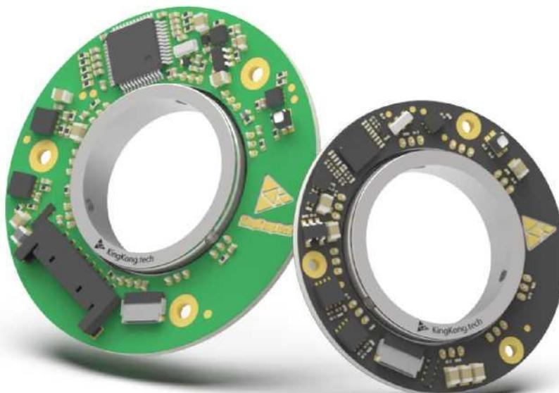
**Магнитный датчик углового положения MBS представляет собой ультратонкий датчик, позволяющий получить абсолютное значение угла поворота. Прибор обладает широким набором выходных интерфейсов и отлично работает в условиях электромагнитных помех. Многообразие размерного ряда обеспечивает точность измерений даже при наличии пространственных ограничений.**
